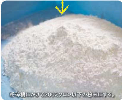
粉碎機にかけて200ミクロン以下の粉末にする。
